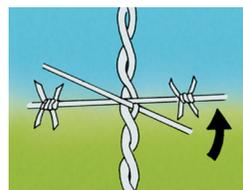
**6** Instalar un trozo de alambre de seguridad entre los alambres del distanciador ECONET, en las hebras centrales del cerco.
