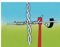
**8** Con la herramienta de torcer, girar las puntas del alambre de seguridad.
