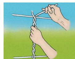
**3** Con la ayuda de la herramienta de torcer, girar las puntas del distanciador ECONET, que sobresalen en la primera hebra del cerco, realizando para esto un movimiento circular.
