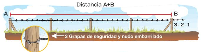
Finalmente, engrape la hebra a las estacas intermedias, es importante no aplastar el alambre con la grapa que sirve de pasador, ya que dañará el recubrimiento de zinc.
